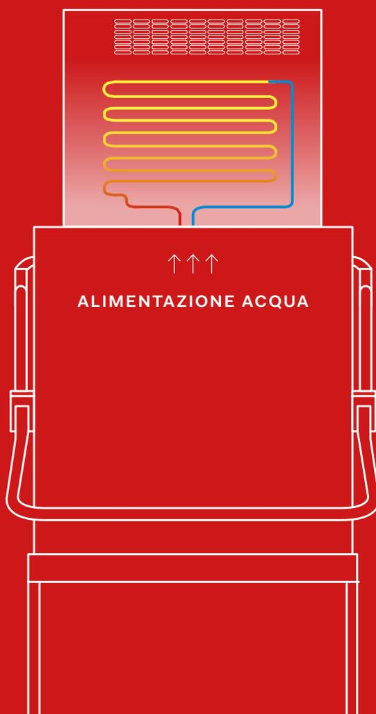
Questo dispositivo aiuta a ridurre il vapore, **creando un ambiente di lavoro più salutare.** I vapori condensati vengono utilizzati per scaldare l'acqua che entra nella macchina, con una significativa riduzione dei consumi di energia. La riduzione dei vapori nella vasca di lavaggio contribuisce ad accelerare l'asciugatura di piatti e bicchieri.
